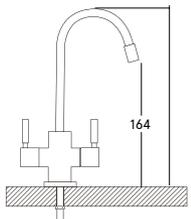
**!** Para conexión a tubo 3/8" pida un conector 3/8" - 7/16" código 953107.
