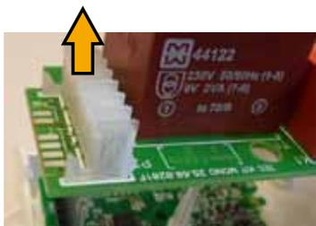
Desconecte la tarjeta de potencia
