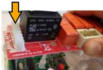
Conecte la tarjeta de potencia de 400 V~
