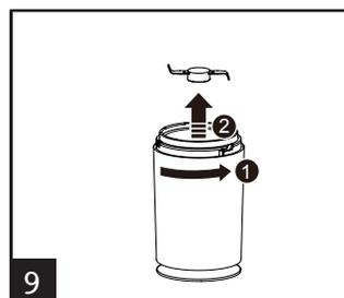
Fig. 1 Coloque las cuchillas girándolas en sentido horario. Tenga precaución cuando manipule las cuchillas
