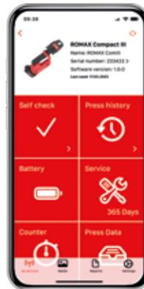
La nueva ROMAX Compact III es la primera prensa inteligente de ROTHENBERGER con conectividad Bluetooth. A través de la aplicación ROTHENBERGER, la herramienta y el Smartphone pueden conectarse, proporcionando al usuario acceso en tiempo real a los datos más importantes de la máquina y del proceso de prensado. Además, la aplicación permite crear fácil y rápidamente protocolos de prensado In Situ, así como leer el estado de mantenimiento actual de la herramienta.
