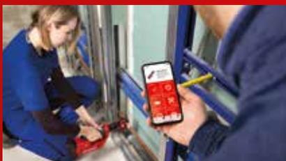
ROTHENBERGER App: registro de la máquina, seguimiento del proceso de prensado en un Smartphone a tiempo real, creación de protocolos e informes.
