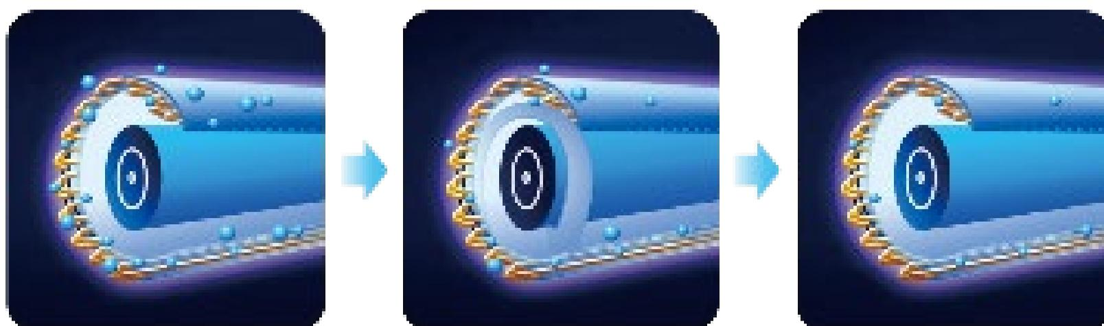
Después de apagar el Split el ventilador funciona durante 3 minutos para secar la batería y evitar la creación de moho.
