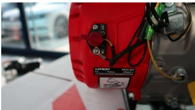
2. Mova a alavanca do acelerador ligeiramente para a esquerda.
