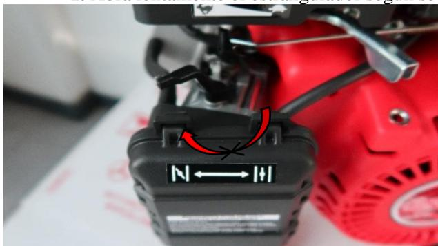
2. Ajuste el aceleradora la velocidad deseada.
