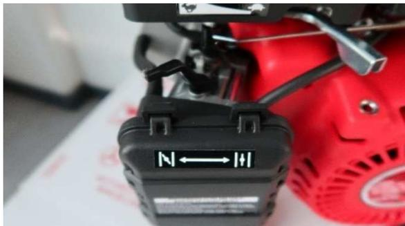
2. Coloque o interruptor do motor na posição OFF
