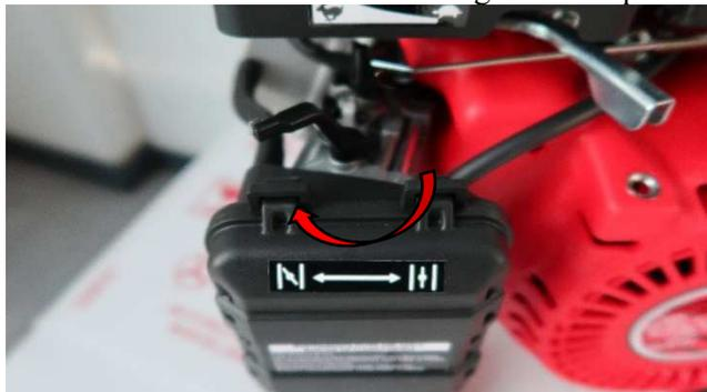
2. Ajuste o acelerador para a velocidade desejada.
