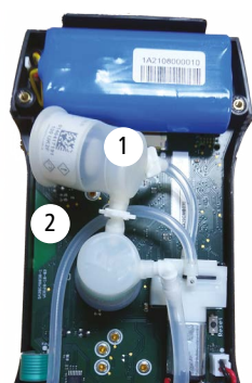
Protección blanca con su sensor retirado
