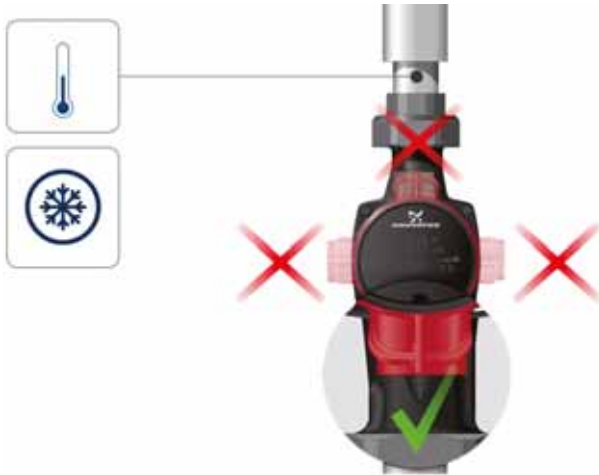
Fig. 4 Posiciones de la caja de control, sistemas de aire acondicionado y agua fría
