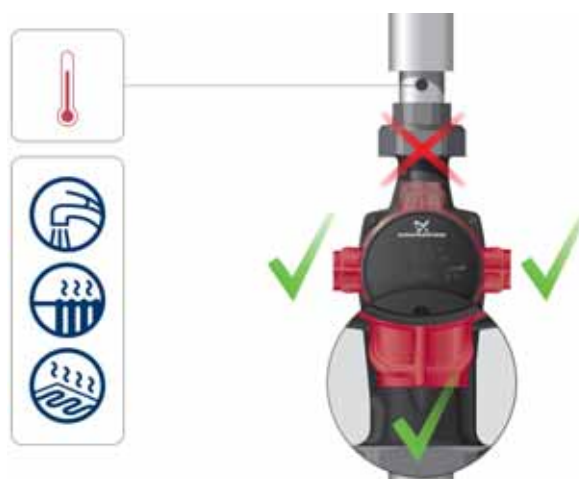
Fig. 3 Posiciones de la caja de control, sistemas de calefacción y agua caliente sanitaria
