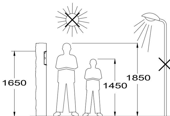
Realizar un agujero en la pared que ubique la parte superior de la placa a una altura de 1,65m.
