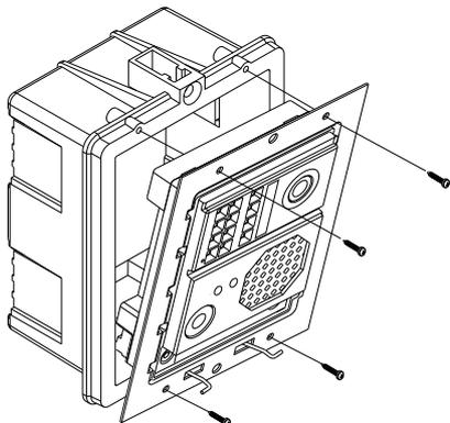
Una vez terminados los trabajos de cableado, configuración y ajustes, fijar el bastidor en la caja de empotrar mediante los tornillos suministrados.
