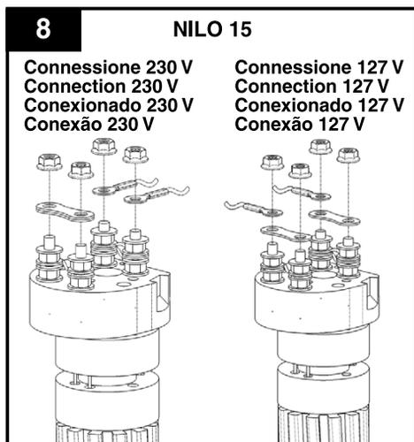
Schema installazione-Installation scheme-Esquema de instalacion-Esquema da instalaçao
