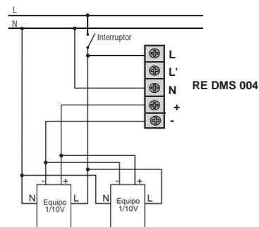
Nota: al alimentar el regulador, después de un apagado, las lámparas se encenderán a su nivel máximo durante 2 minutos.
