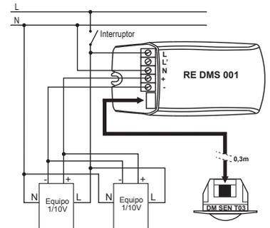
Nota: al alimentar el regulador, después de un apagado, las lámparas se encenderán a su nivel máximo.
