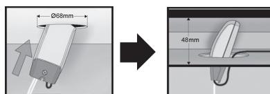
Para instalar el sensor, taladre en el techo un orificio de 65mm de diámetro y mantenga el cable por dentro.
