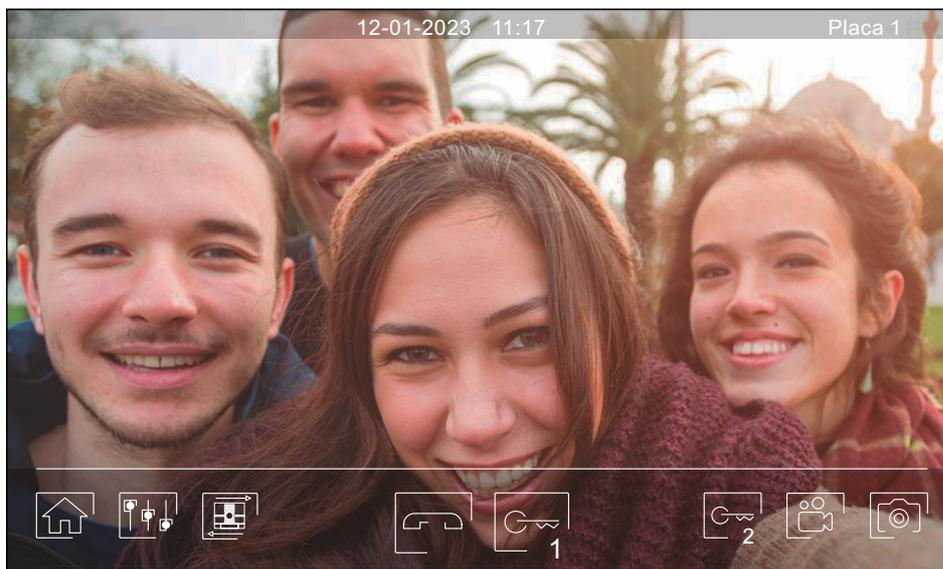
Esta pantalla se muestra durante un proceso de comunicación. En la parte superior central de la pantalla se muestra la fecha y la hora, y a la derecha se muestra la fuente de origen de la imagen. La comunicación tiene una duración máxima de 90 segundos.
