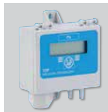
TDP-S/TDP-D/TDP-PI Transmisores de presión. Se utilizan para controlar la presión en sistemas de ventilación en presión constante. Permiten la lectura de la diferencia de presiones entre dos puntos y la transforman en una señal eléctrica apta para los diferentes equipos de control.
