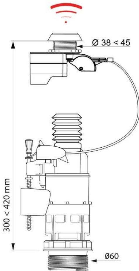
COMPATIBLE CON TODAS LAS BASES DE ROCA PARA UNA INSTALACIÓN SIN DESMONTAR LA CISTERNA
