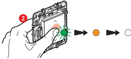
Presione **brevemente** el comando inalámbrico para encenderlo, el LED parpadeará en color verde, cambiará a naranja fijo y se apagará.
