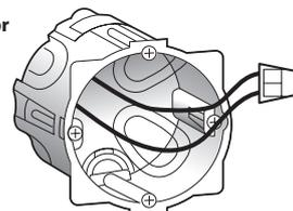
Use un **conector** para conectar los dos cables.
