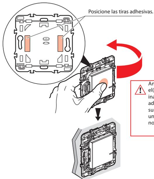
⚠ Antes de fijar el(los) comando(s) inalámbrico(s) con los adhesivos reutilizables suministrados, realice una prueba en un área no visible de la pared.
