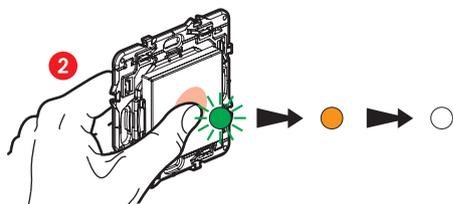
Presione **brevemente** el comando inalámbrico para encenderlo, el LED parpadeará en verde, cambiará a naranja fijo y se apagará.
