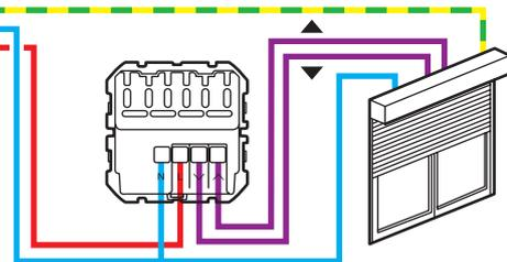
La solución Valena Next with Netatmo es compatible con motores de persianas con final de carrera mecánico o electromecánico, controlados por un interruptor eléctrico convencional. No son compatibles
