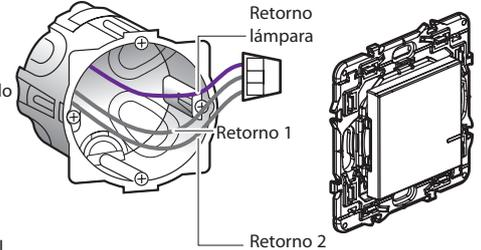
Use un **conector** para conectar los 3 cables juntos (retornos 1, 2 y el retorno de la lámpara).
