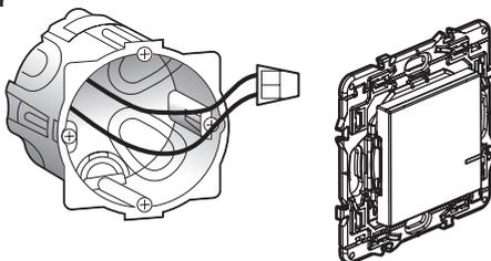
**⚠ El circuito debe estar protegido por un interruptor magnetotérmico de 16 A**
