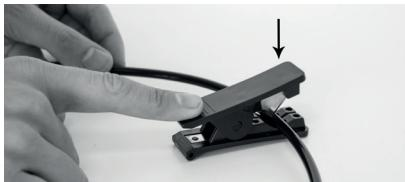
2. Utilizar o afiador fornecido para criar um apoio cônico necessário para uma correcta ligação.
