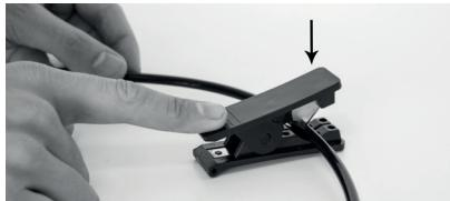
2. Utilizzare il rifila tubi per creare un invito conico necessario per il corretto inserimento del raccordo.
