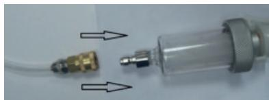
4. Connettere il tubo di aspirazione alla macchina nella connessione inferiore.
