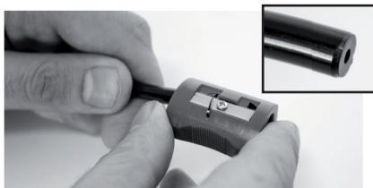
3. Empuje fuerte el tramo de tubería cortado dentro del conector
