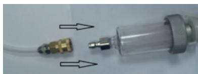
4. Conecte la tubería de succión a la máquina en la conexión inferior.
