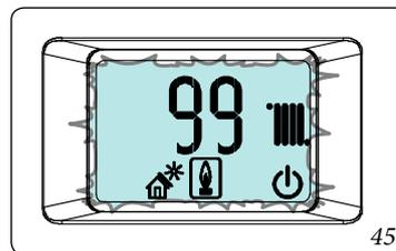
Solo después de parpadear el símbolo "🔥" se puede corregir el valor de CO<sub>2</sub> (Apdo. 3.11) o pasar a la potencia siguiente presionando el pulsador "POWER".
